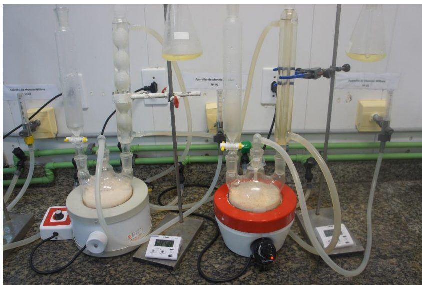
Figura 5: Análise residual de SO 2 , através do método de Monnier-Willians, realizada no Laboratório de análises química da empresa Potiporã
