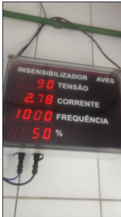
Figura 18: Painel de controle da cuba de insensibilização. (Acervo do Autor, 2018)
