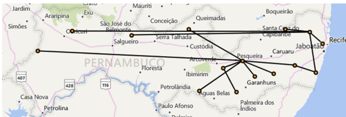
Figura 37 – Mapa da rede com menor CAPEX encontrada na iteração 500 do método com busca local.
