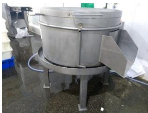
Figura 12 - Dispositivo utilizado para remoção das escamas na Unidade Beneficiadora de Pescados Qualimar. Fonte: Arquivo pessoal, 2018.
