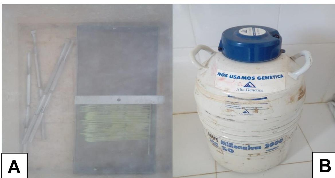
**Figura 4** - Palhetas, bandeja, racks na caixa de isopor submersos em  $N_2$  (A) e botijão de  $N_2$  (B).
