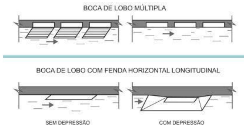
Figura 2. Variações dos tipos de boca de lobo.
