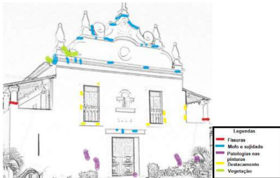
Figura 16- Mapa de danos ilustrativo das patologias encontradas na fachada da Igreja de Nossa Senhora do Loreto.
