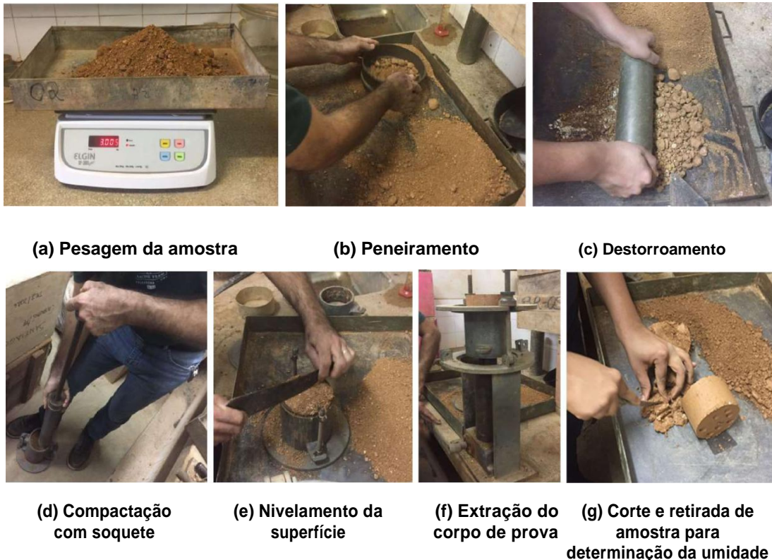
Figura 7: Procedimento do ensaio de compactação
