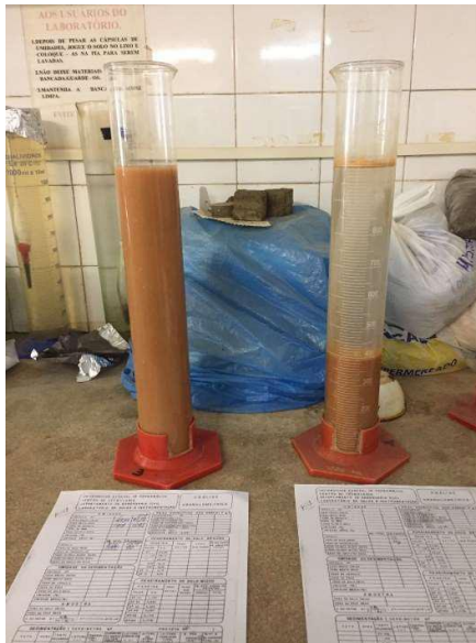
Figura 4: Provetas com o solo durante a etapa da sedimentação. A da esquerda contém a amostra com defloculante e a da direita contém a sem defloculante.
