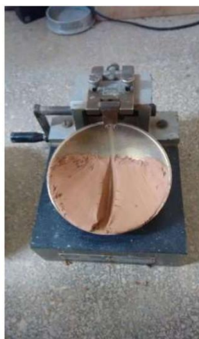
(b) Aparelho de Casagrande com amostra
