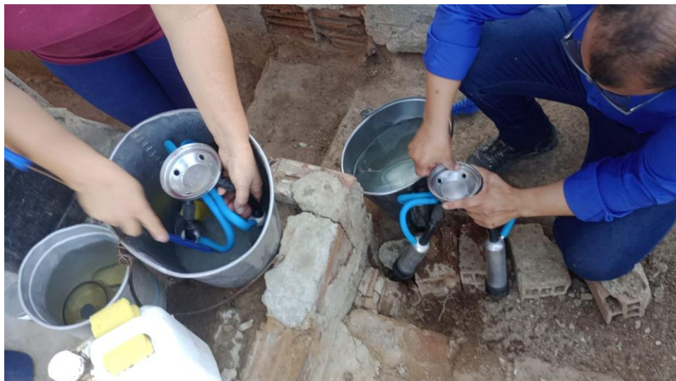
Figura 5. Limpeza excepcional de conjuntos de ordenha com muita sujeira (normalmente deve ser feita apenas com os produtos e fluxo da água) e posterior instrução da correta higienização do maquinário.
