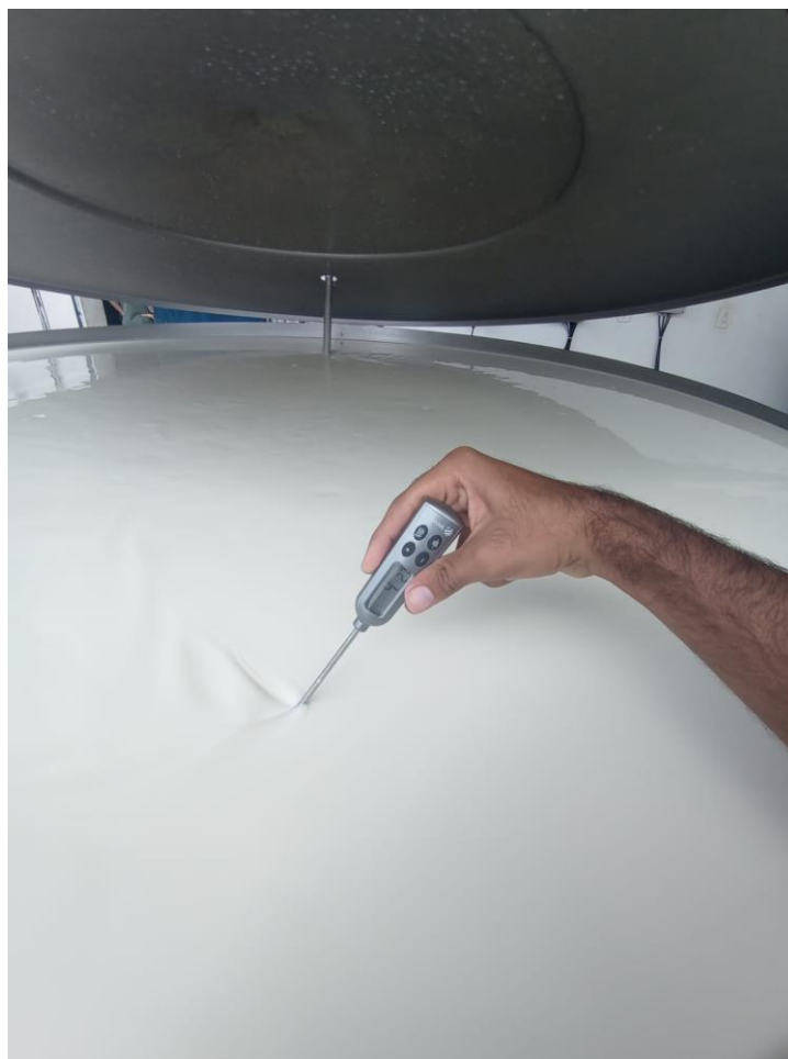
Figura 17. Aferição da temperatura do leite em tanque resfriador.
