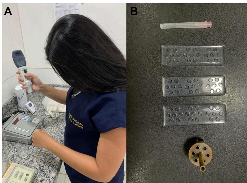
**Figura 10.** A) Processo de elaboração de lâminas com micropipeta em laboratório. B) Lâminas cortadas em formato de roseta distribuídas uniformemente e um adaptador para corte.
