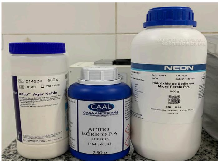
**Figura 9.** Materiais e reagentes empregados na formulação do tampão borato, incluindo ácido bórico, agar noble e hidróxido de sódio P.A.
