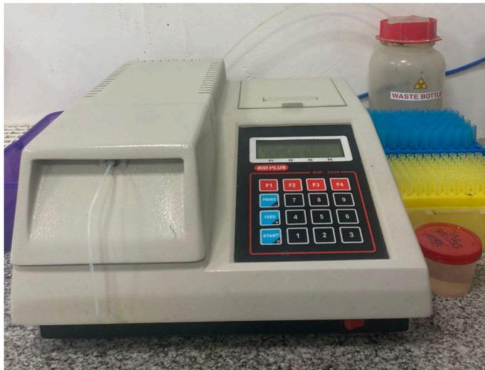
**Figura 25.** Analisador bioquímico semiautomático Bio Plus Bio 2000®: equipamento utilizado para a determinação de parâmetros bioquímicos em amostras biológicas.
