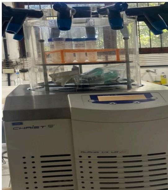
**Figura 35.** Equipamento Alpha 1-4 LD Plus Christ: sistema utilizado para liofilização de amostras biológicas.
