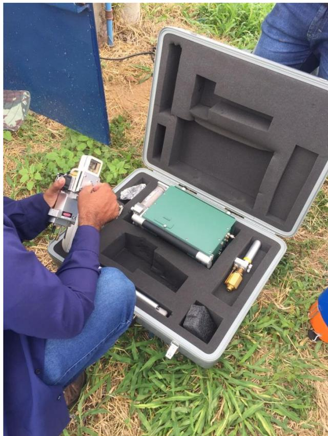
**Figura 6. - Analisador de gás infravermelho**
