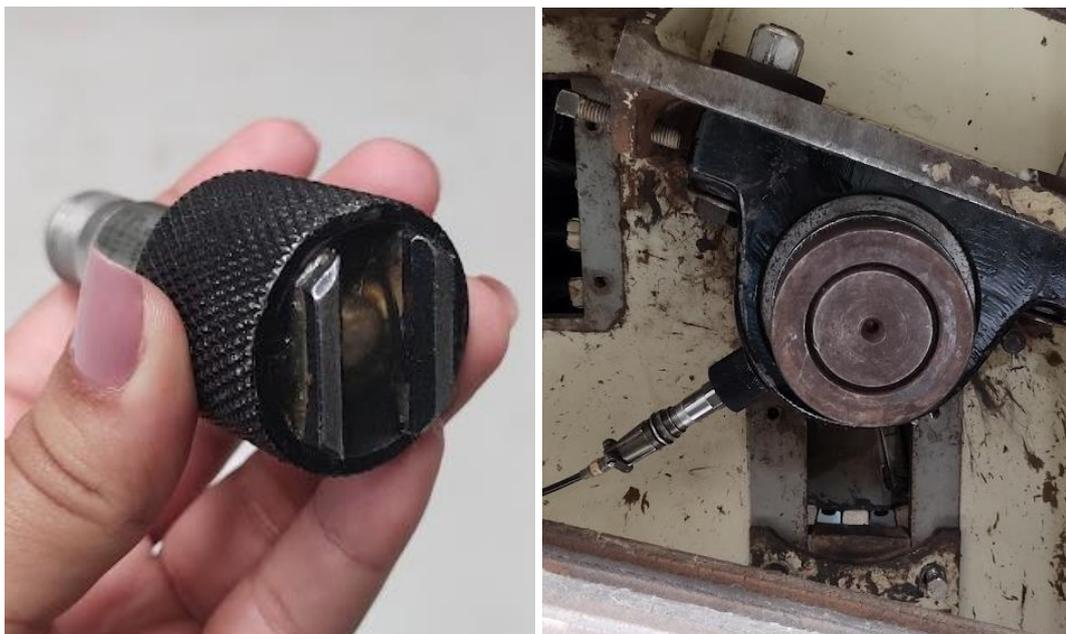
A terceira porta de entrada refere-se ao Laser analisador de rotações por minuto, um sensor de posição e rotação, acoplado a uma superfície plana da máquina
