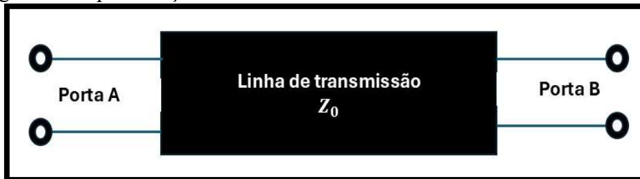
Figura 1 - Representação de uma linha de transmissão como uma rede de duas portas.
