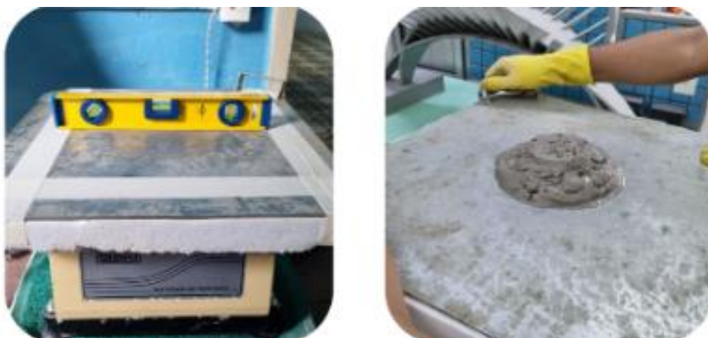
Figura 39: Equipamento adaptado para o ensaio de consistência e ensaio.
