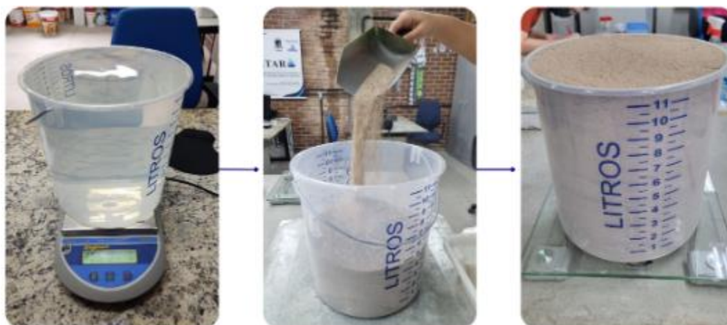
Figura 21: Pesagem da água para determinar o volume do recipiente e enchimento do recipiente.
