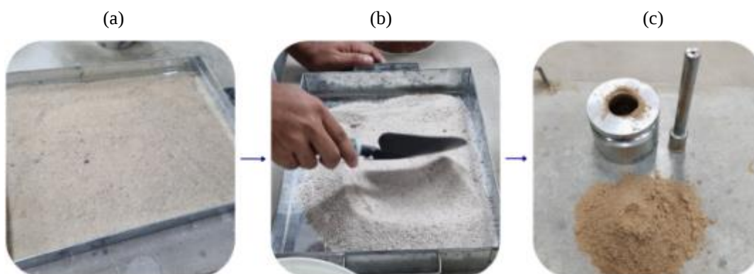
Figura 22: (a) Saturação da areia, (b) revolvimento e (c) amostra em condição de saturação superfície seca.
