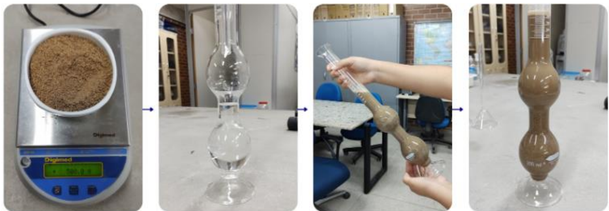
Figura 24: (a) Pesagem da massa de areia, (b) preenchimento do frasco com água, (c) agitação do conjunto água-areia, (d) repouso do frasco para efetuar a leitura do nível.
