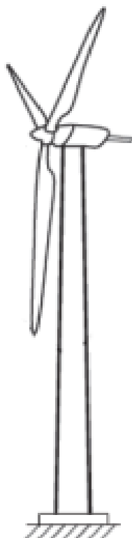
Figura 2 – Turbinas eólicas com eixo horizontal.
