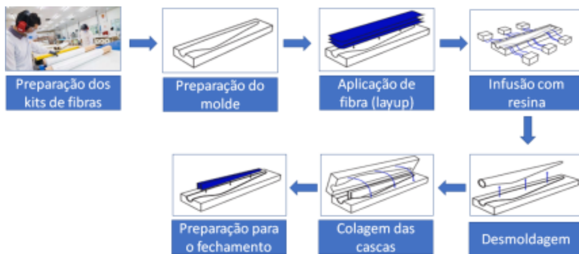
Figura 8 – Fluxo do processo de produção de pá eólica.
