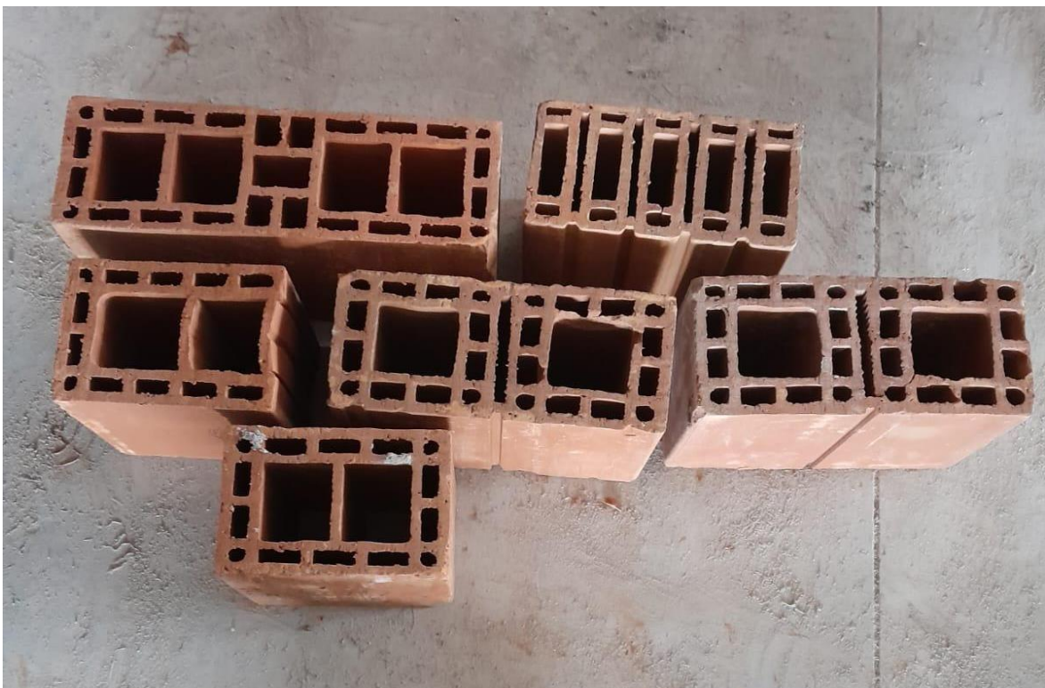
Figura 7 - Família de blocos de vedação externa utilizados na obra.
