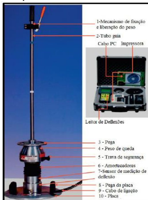
Figura 3 – Estrutura de um equipamento de LWD padrão.
