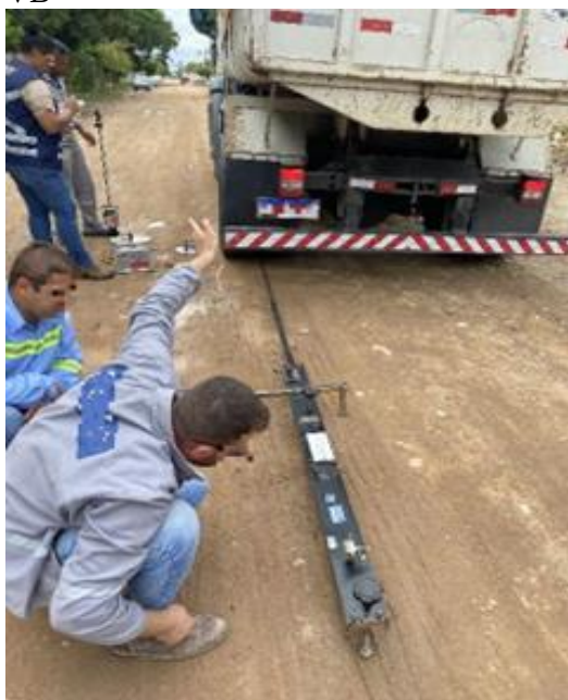
Figura 6 – Realização dos ensaios de LWD e VB
