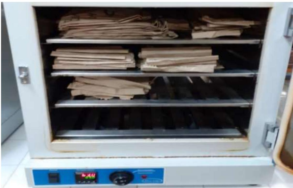
**Figura 05.** Estufa de circulação de ar utilizada para atingir a massa seca do capim-corrente, Laboratório de química da UFRPE-UAST.
