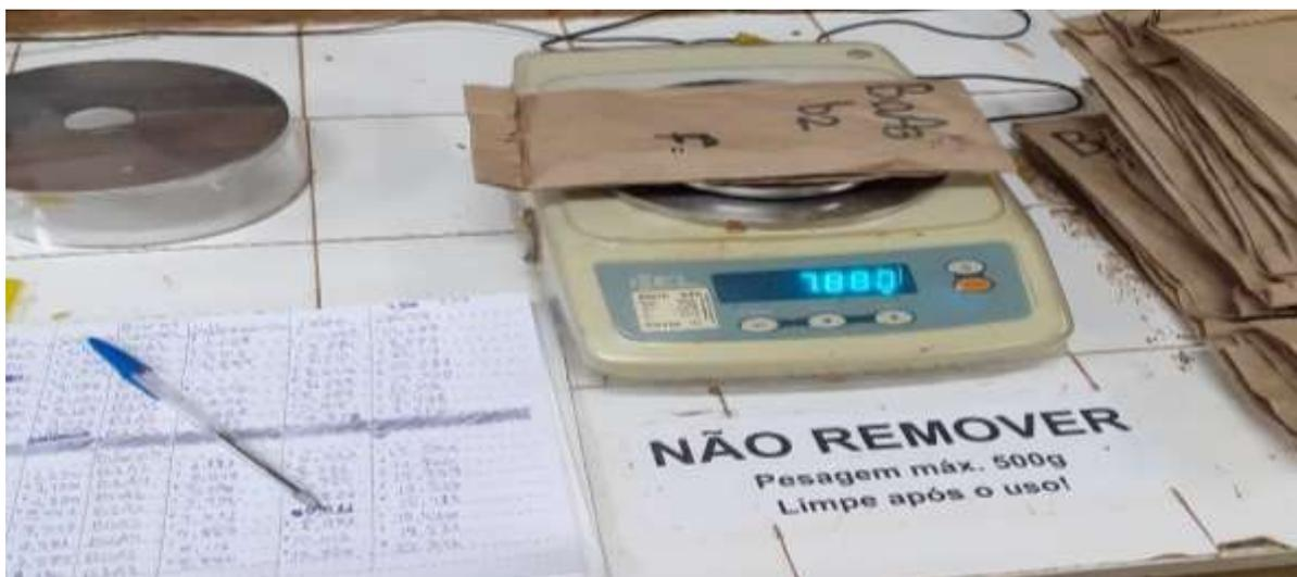
**Figura 04.** Balança semi-analítica utilizada para mensurar a massa fresca e massa seca do capim-corrente, UFRPE-UAST, Dez. 2019.
