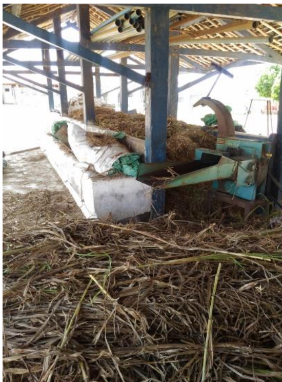
Figura 21: Processo de trituração do Capim-Elefante na máquina forrageira (arquivo pessoal).
