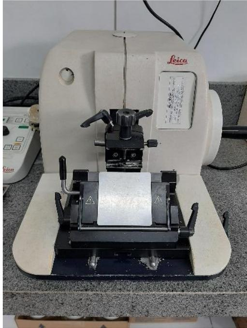
Figura 5. Micrótomo utilizado para corte histológico de amostras de gônadas de *Anisotremus surinamensis*. Este equipamento permite realizar cortes finos, com espessura de aproximadamente 6 micrômetros, essenciais para a preparação das lâminas destinadas à análise microscópica dos estágios de maturação reprodutiva da espécie. Fonte: Rafael leite
