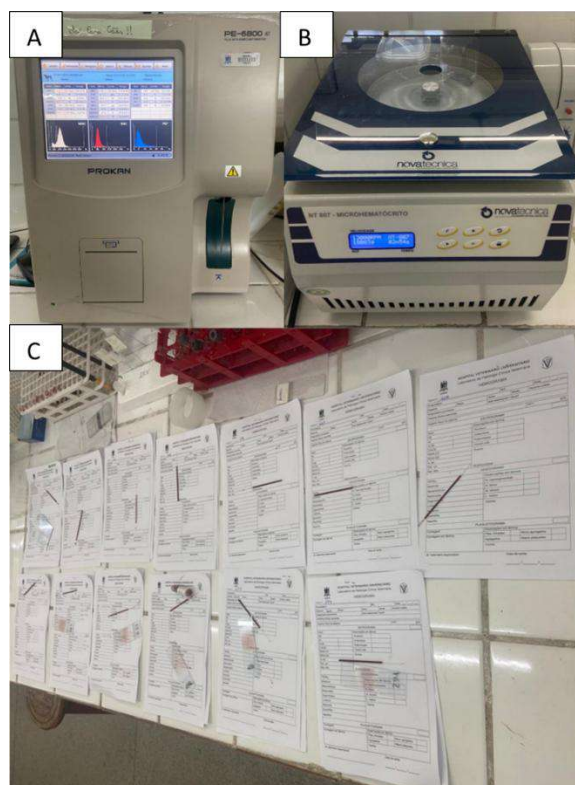
Figura 3 - A: Analisador hematológico PROKAN PE6800 VET. B: Microcentrífuga Novatecnica NT-807. C: Bancada de hemogramas.
