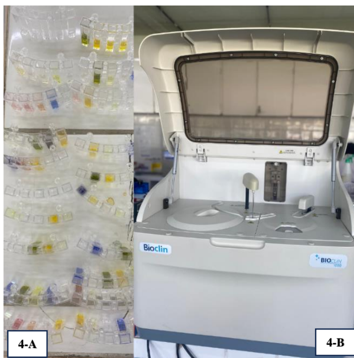
FIGURA 4-A: Cubetas utilizadas pelo analisador bioquímico para as reações químicas. FIGURA 4-B: Analisador bioquímico (Bioclin 1000 ® ) utilizado na rotina do LPCV.
