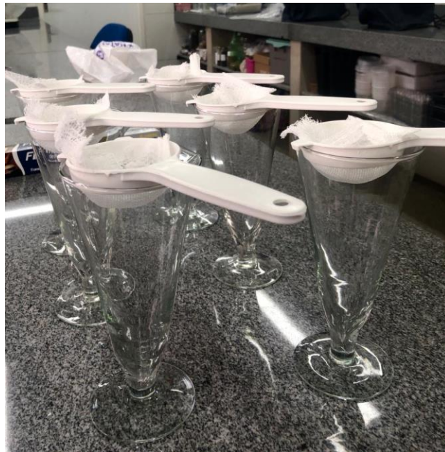
Figura 3. Cálices cônicos para armazenamento do líquido resultante da lavagem das uvas.
