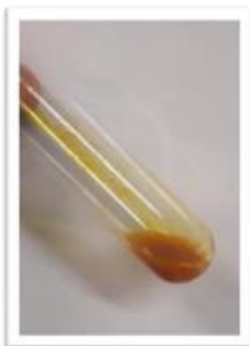
Figura 5 - Aspecto geral do tubo de ensaio com o resultado mostrando alíquotas nas paredes do tubo além da coloração avermelhada após a adição do indicador Dragendorff, resultado positivo para alcaloides. Fonte: PEREIRA, V. L. C. (2021).
