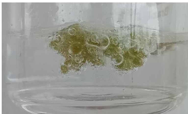
Figura 12. Formação de bolhas de ar nos estigmas imersos em peróxido de hidrogênio a 3% como reação à presença da enzima peroxidase.
