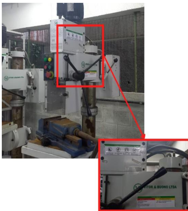
Figura 21- Furadeira MD 325A com placa de sinalização.
