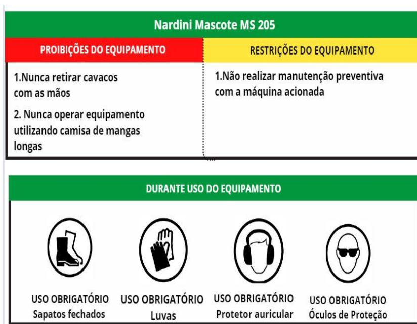
Figura 14- Modelo de placa de Sinalização de Equipamentos.
