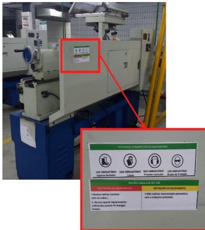
Figura 18- Torno Nardini Mascote MS 205 com placa de sinalização.
