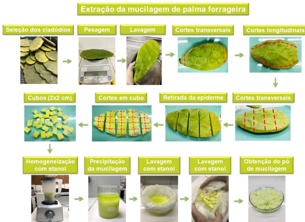
Figura 4. Fluxograma da extração de mucilagem de palma forrageira ( Nopalea cochenillifera Salm-Dyck), desde seleção dos cladódios até a obtenção do pó, o qual é utilizado para elaboração dos biofilmes. As linhas tracejadas em vermelho simbolizam o sentido do corte.
