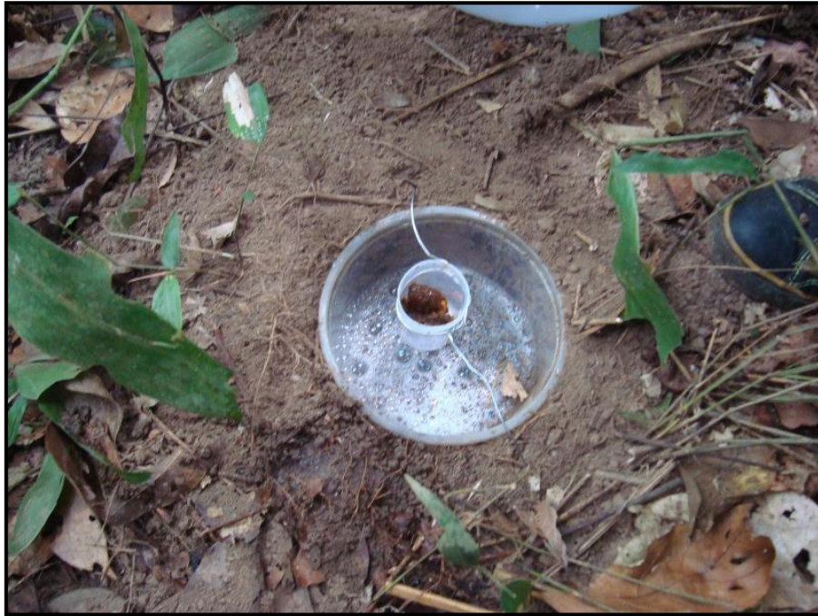
Figura 6: Foto da armadilha de queda do tipo “ pitfall ” instalada no campo.
