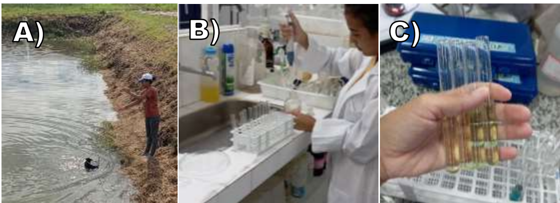
Figura 10. (A) Coleta de água; (B) Preparo de solução para análise; (C) Teste fotocolorimétrico.
