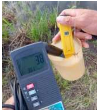
Figura 9. Aferições de pH com pHmetro, oxigênio (mg/L) e temperatura (°C) com oxímetro.
