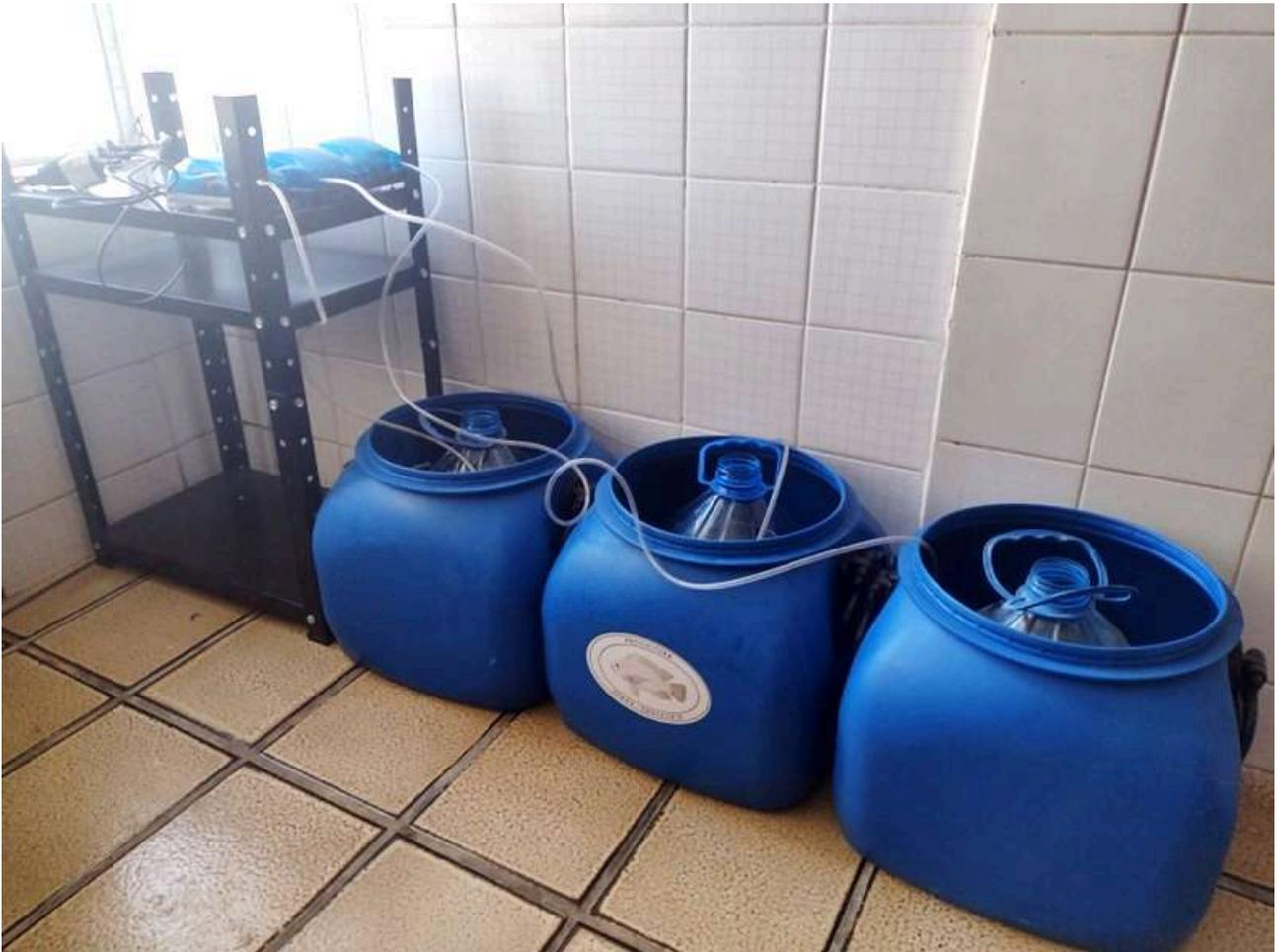
Figura 05: Aspecto do modelo experimental, com três tanques não translúcidos (azuis), e três garrações PET inseridos dentro de cada um (Foto: Fernando Porto, 2024).
