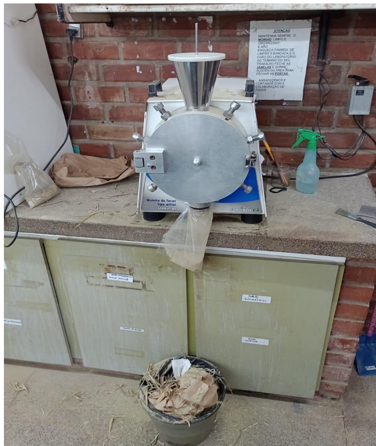
Figura 9. Moinho de facas tipo Willey para processamento das amostras.
