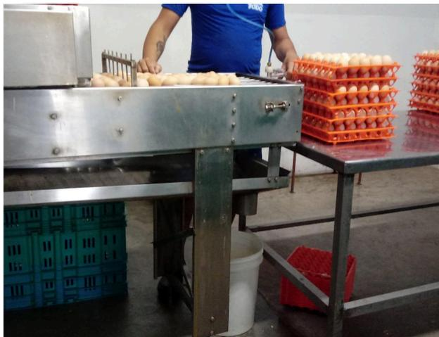
**Figura 13.** Máquina classificadora de ovos do incubatório (Fonte: Acervo pessoal)
