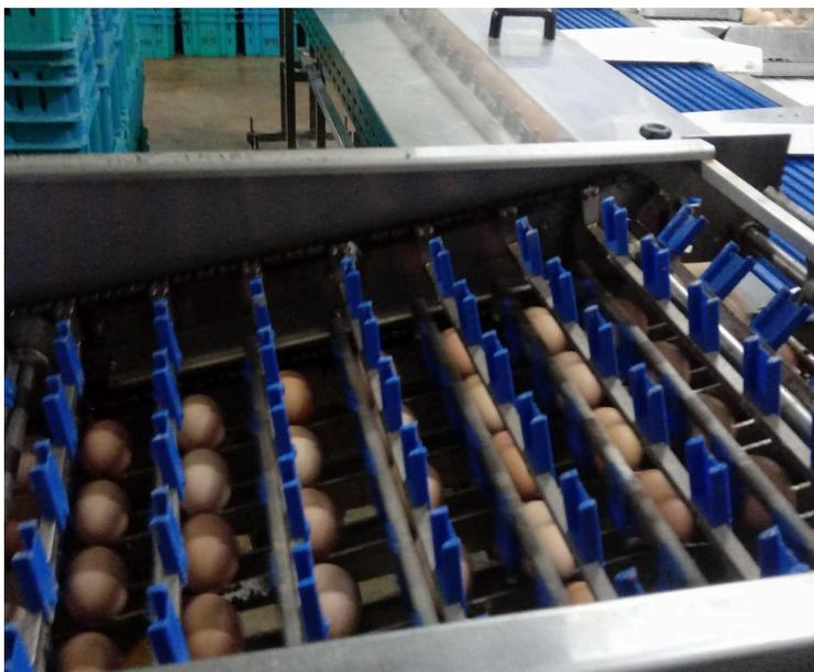
**Figura 16.** Balança de classificação de ovos do incubatório (Fonte: Acervo pessoal)
