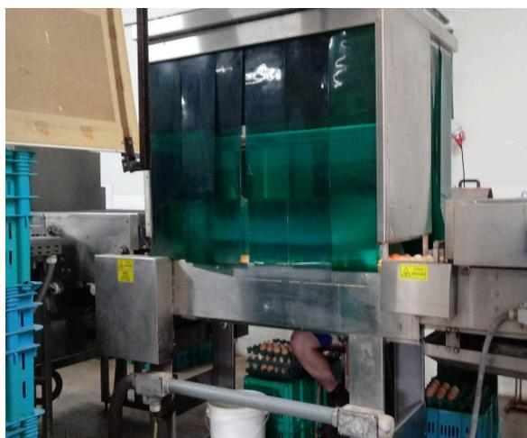
**Figura 14.** Máquina de ovoscopia do incubatório (Fonte: Acervo pessoal)
