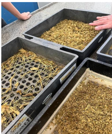
Figura 25. Peneiras utilizadas para análise granulométrica do alimento.
