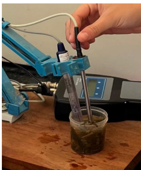
Figura 26. Amostra de silagem para medição de pH.
