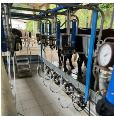
Figura 12. Ordenha automatizada espinha de peixe do CMBSB.
