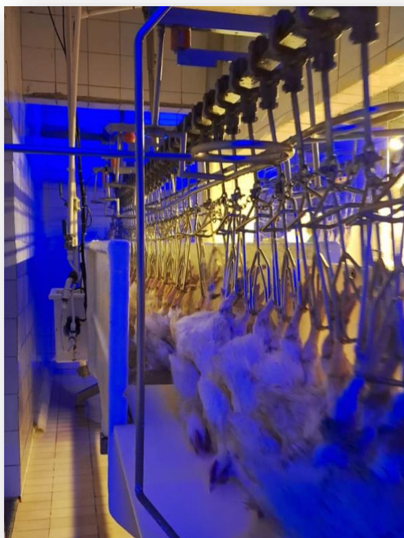
Figura 87. Aves sendo imersas no tanque de insensibilização
