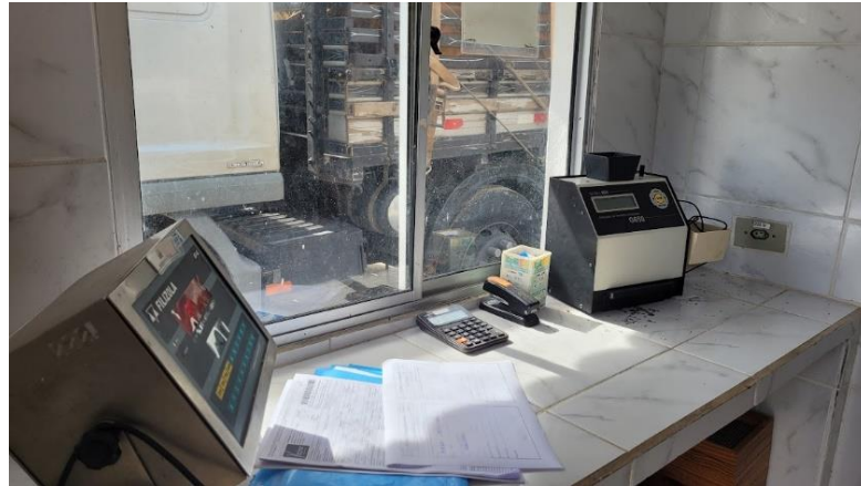
Figura 4. Sala de pesagem com visor da balança rodoviária e analisador de umidade
