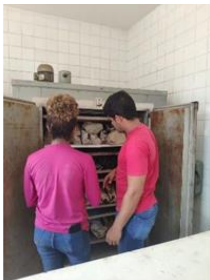
Figura 8. Material sendo colocado em estufa com ventilação forçada de ar. Fonte: Autores, 2022.
