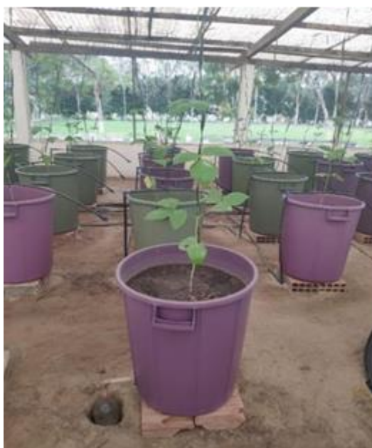
Figura 6. Lisímetro de drenagem e garrafa PET utilizada para a coleta do drenado. Fonte: Autores (2021).
