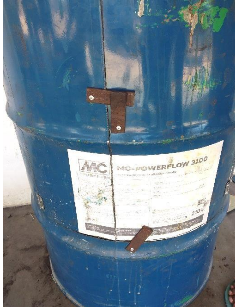
Figura 13 – Fechadura na parte superior do defumador.
