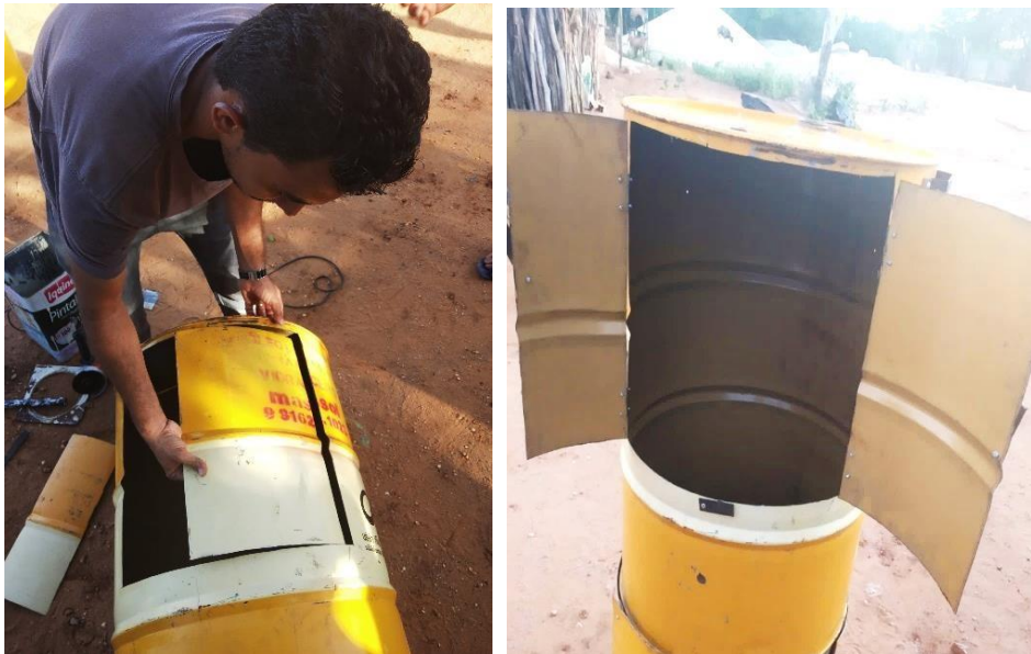
Figura 12 – Corte e fixação da porta.
