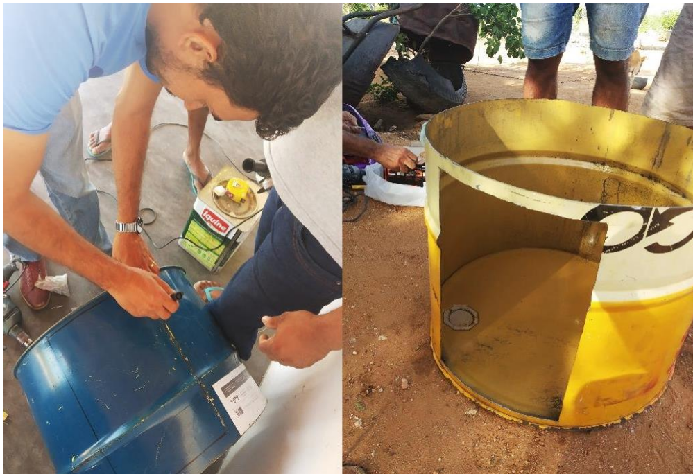
Figura 6 – Marcação e abertura de porta da base do defumador.
