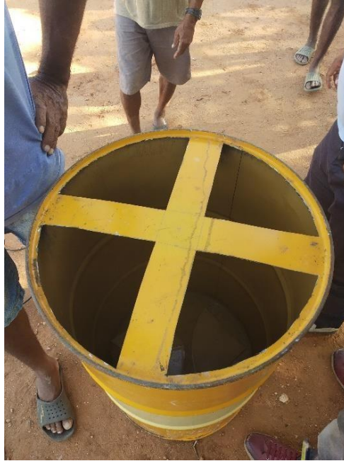
Figura 11 – Parte superior do defumador finalizada.
