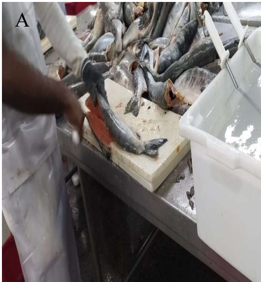
Figura 8 - Processo de Filetagem do salmão chum: A - Filetagem do salmão chum de forma manual; B - Filetagem do salmão chum de forma mecanizada; C - Remoção de espinhas do filé de salmão de forma mecanizada; D - Remoção de espinhas do filé de salmão de forma manual.
