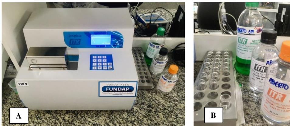
**Figura 09.** (A) Crioscópio digital. (B) Soluções-padrão para calibração.
