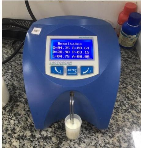
**Figura 10.** Analisador automático de leite (Lactoscan®).
