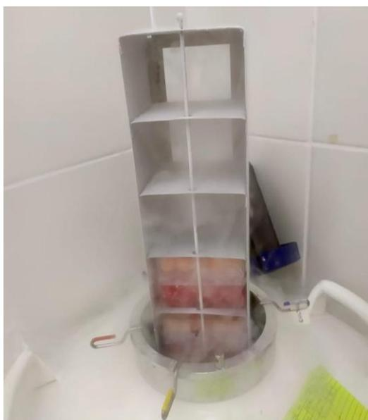
**Figura 18.** Estirpes de *Leptospira* spp. armazenadas em nitrogênio líquido a -196°C.
