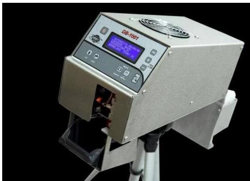
Figura 35 – Máquina debicadora (Técnica holandesa – em “V”). Fonte: MFRural, 2022.
