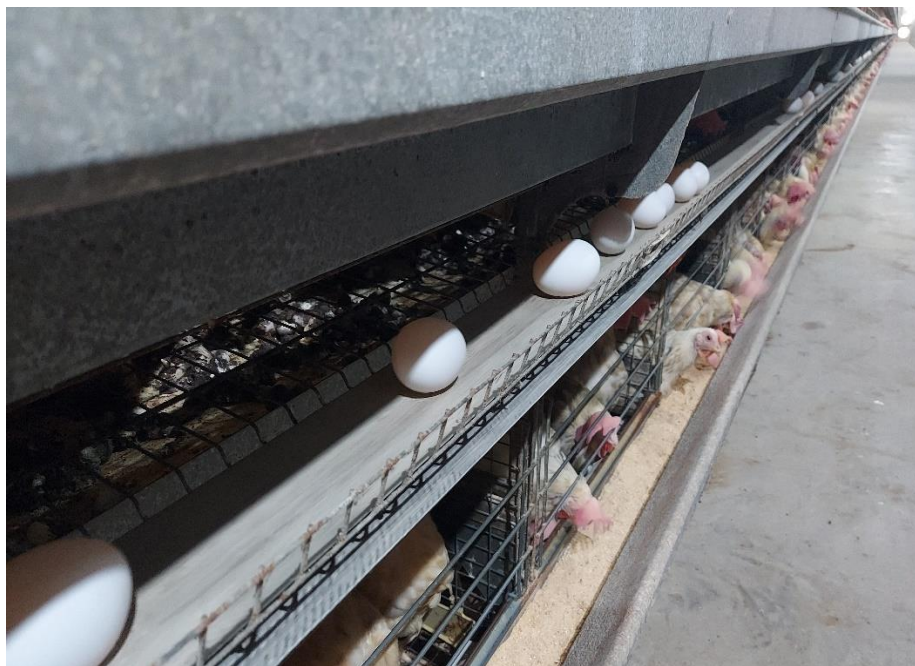
Figura 22 – Esteira de ovos comerciais e comedouros automáticos. Fonte: Pacheco, 2024 (Autorizado pela empresa).
