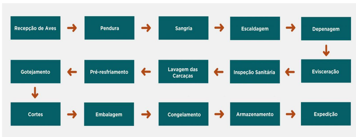
Figura 28 – Fluxograma de abatedouro de frango de corte. Fonte: BTA Aditivos, 2019.
