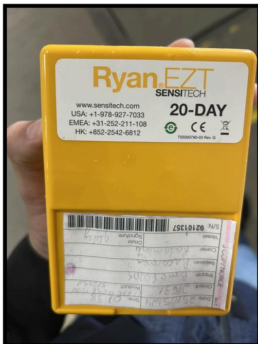
**Figura 24.** Termômetro datalogger analógico.
