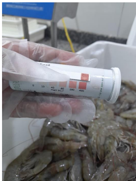
Fig. 3 – Fita Reativa de Merck para Avaliação do Teor Residual de SO 2
