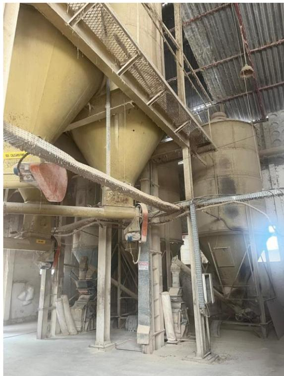
**Figura 27.** Silo de armazenamento
