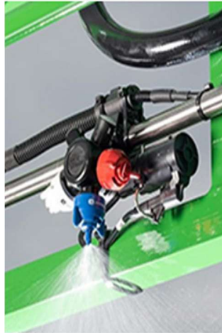
Figura 3 –Torre de bicos Fonte: Catálogo JhonDeere.
