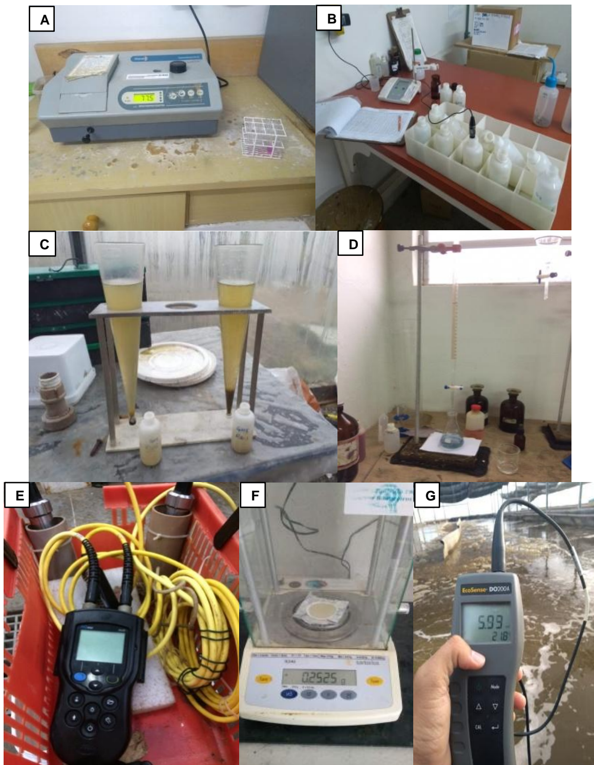
Figura 16 - Equipamentos utilizados para a análise de água. (A) Espectrofotômetro; (B) pHmetro de bancada e amostras de água; (C) Cones de Imhoff; (D) Análise de alcalinidade; (E) Multiparâmetro; (F) Balança analítica com filtro de SST e (G) Oxímetro.
