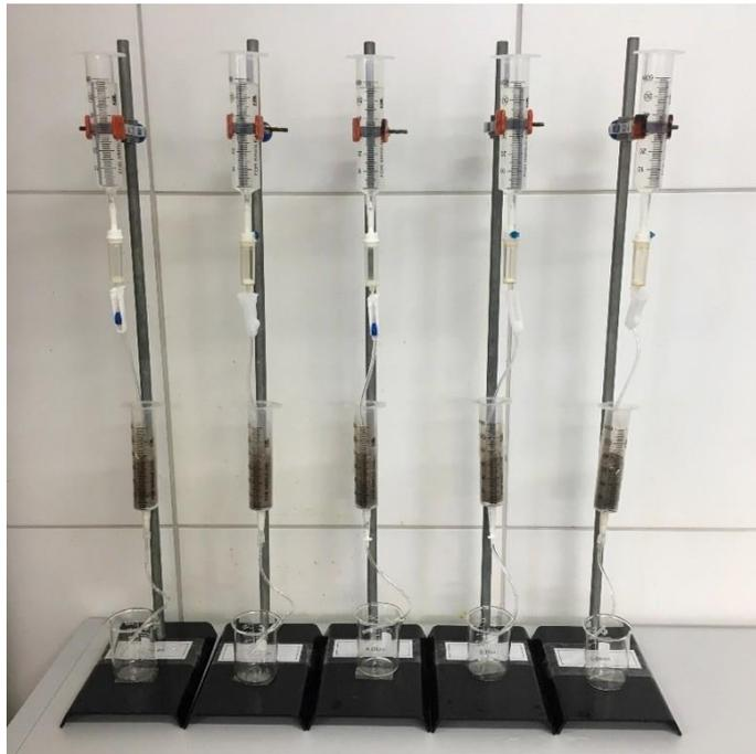
Figura 2. Estrutura construída para a realização dos testes de retenção de umidade, utilizando a água de tanques de piscicultura (FFW) e a convencional (TW), em amostras de argissolo vermelho-amarelo distrófico (PVAd).
