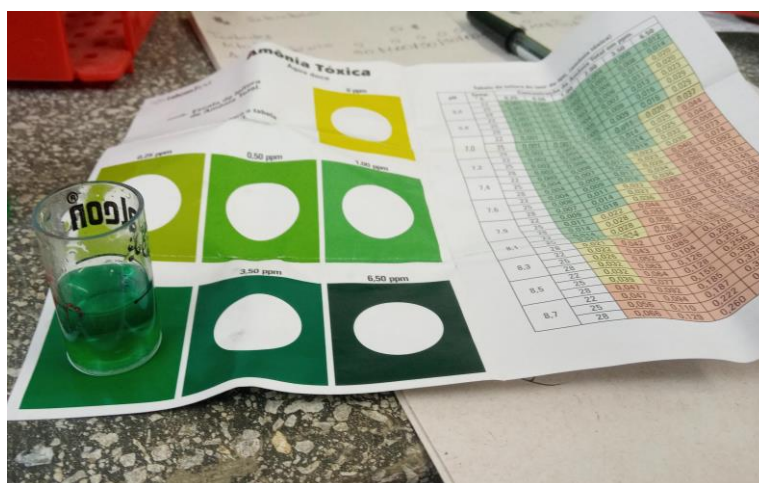
Figura 19. Análise da água do açude Cachoeira II, Serra Talhada - PE, utilizando a tabela de resultados do Labcon Test Amônia Tóxica.
