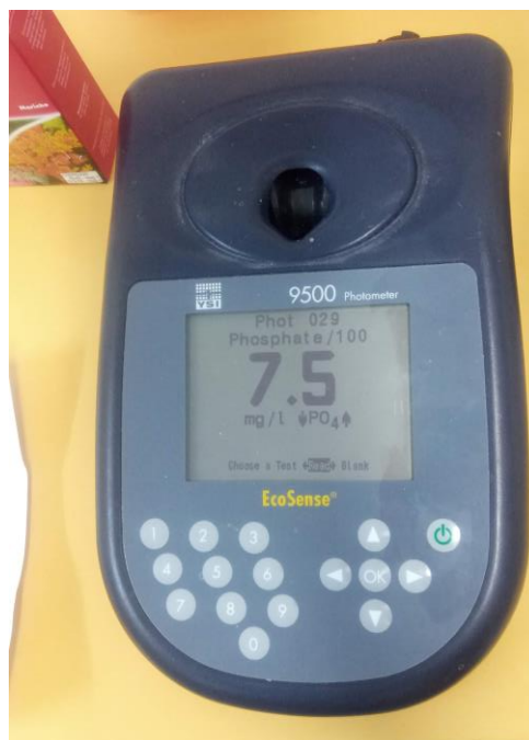
Figura 10. Análise do fósforo (P) na água através do Ecosense 9500 photometer.
