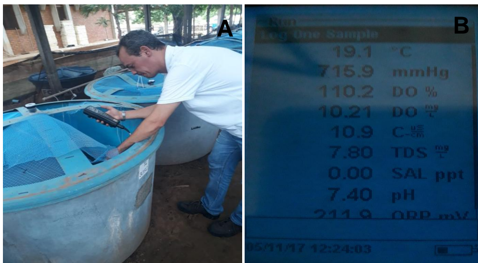
Figura 5 A. Equipamento multiparâmetro usado no monitoramento da qualidade da água. B. visor do multiparâmetro.
