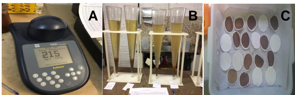
Figura 6 A. aparelho fotômetro usado na análise da qualidade da água. B. Cone de Inhoff utilizado para realizar a análise de sólidos sedimentáveis. C. Filtros de fibra de vidro utilizados para realizar a análise de sólidos suspensos totais.
