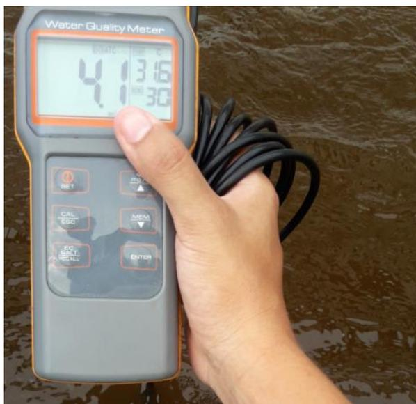
**Figura 3.** Aparelho de oxímetro mensurando os parâmetros de temperatura e oxigênio dissolvido.
