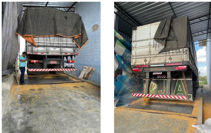
Figura 17. Descarregamento de Milho em grãos direto na moega.
